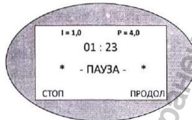
**Рисунок 12 Вид экрана в режиме паузы**
